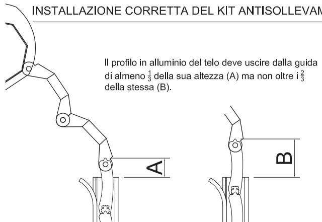
Il profilo in alluminio del telo deve uscire dalla guida di almeno  $\frac{1}{3}$  della sua altezza (A) ma non oltre  $\frac{2}{3}$  della stessa (B).
